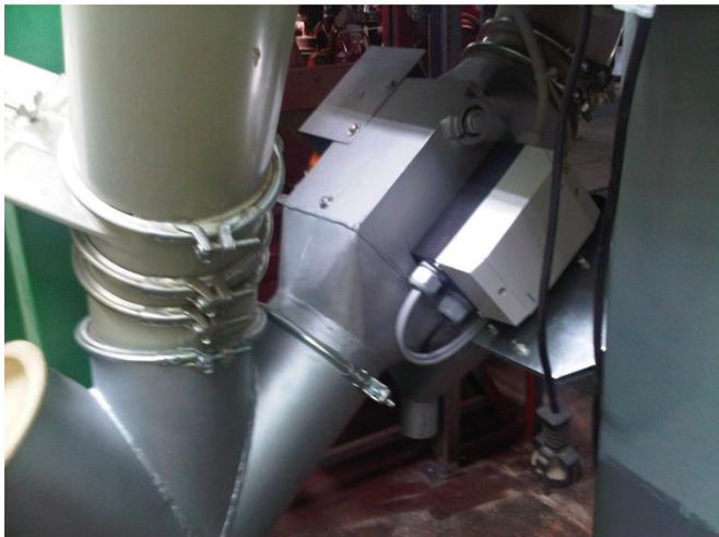
Im Saatgutstrom (Fördereinrichtung) eingebautes automatisches Probenahmegerät (Foto: Thiel, W.)
