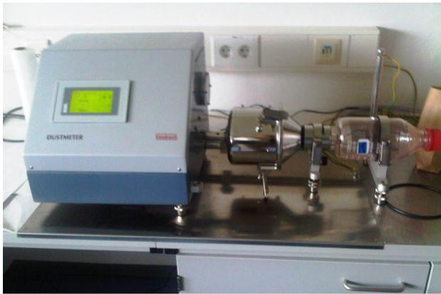
Heubach-Messgerät zur Ermittlung von Beizstaubabrieb
